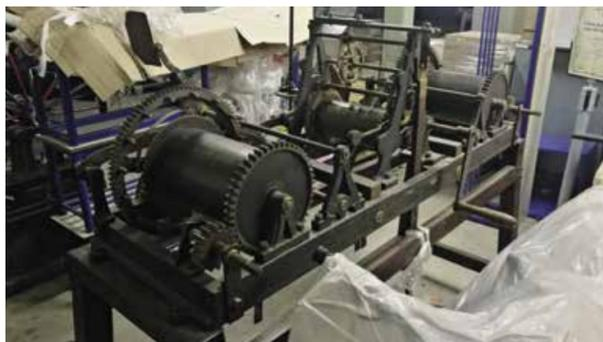
Oggi l'orologio è conservato presso i magazzini comunali in attesa di una sistemazione. Tutti i componenti necessari al funzionamento dell'orologio e del suo pendolo sono presenti e funzionano correttamente. Mancavano purtroppo già al momento dello smontaggio, alcune parti dei meccanismi per il controllo delle suonate delle ore e dell'angelus.
